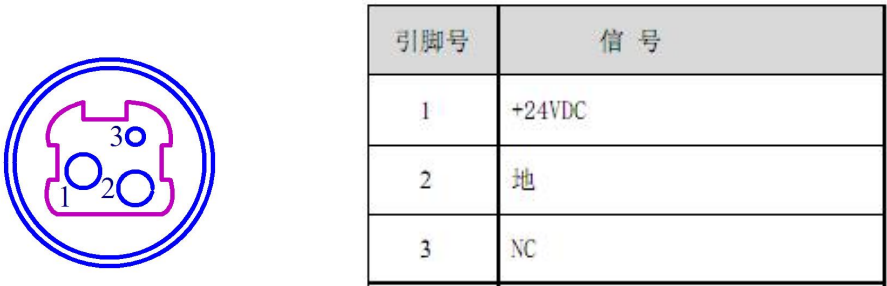
图 3-4 电源插座及引脚定义
